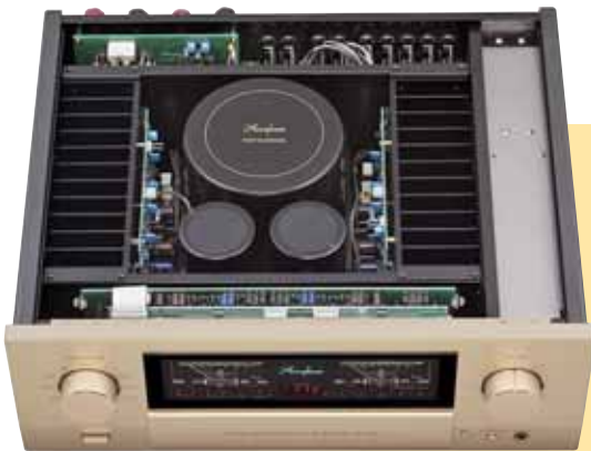
Das Netzteil mit fettem Trafo und dicken Kondensatoren nimmt zusammen mit den Endstufen fast den gesamten Innenraum des Verstärkers ein. Der Schacht für die Module rechts ist zum Schutz vor Einstrahlungen gekapselt
