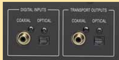
Neben koaxialem und Lichtleiter-Digital-Ausgang besitzt der DP-510 auch ebensolche Inputs, ist also für externe Bit-Lieferanten als hochwertiger DAC nutzbar
