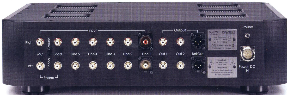
Den Phonobuchsen (ganz links) können über ein zweites Buchsenpaar Cinchstecker mit eingebauten Lastwiderständen parallelgeschaltet werden. Ganz rechts oben: ein bisweilen praktischer „Ground Lift“-Schalter
